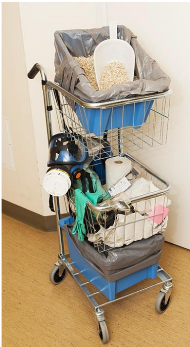
Bilden visar ett exempel på en saneringsvagn från ett laboratorium där man hanterar hälso-och miljöfarliga kemikalier
