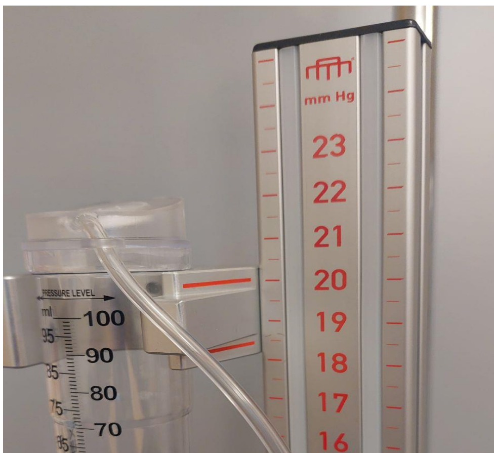
Bild 2. Den svarta pilen (pressure level) ska vara jäms med det översta röda strecket som sedan justeras mot ordinerad mmHg på stativet, i detta fall 20 mmHg.
