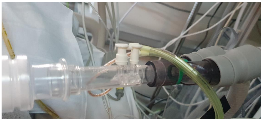
Bild 2. Kalorimeters spirometri uppkopplad med HDMI filter. Tryckmätare (gröngula) och flödesmätare (kopparfärgad) ska vara riktade uppåt/snett uppåt.
