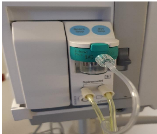
Bild 1: Korrekt insatta kopplingar till kalorimeter.
