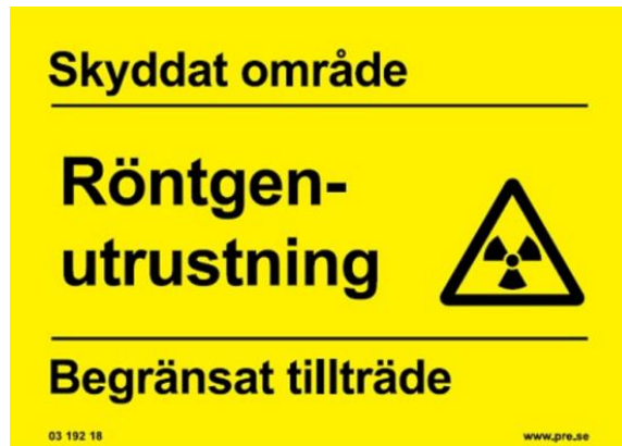
Bild 1: Korrekt skyltning för lokal klassad som skyddat område.
