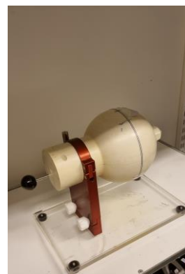
Figur 1. Cylindriskt plexiglasfantom (t.v.) och stereotaktiskt skallfantom (t.h.).
