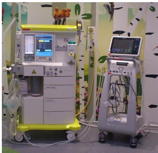
Figur 6. Anestesiutrustning vid DSBS. Notera att utrustningen står utanför 10 mT-gränsen.
