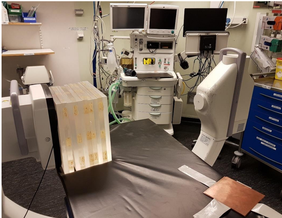
Figur 3: Denna uppställning används för att kontrollera tjocklekskompensation
