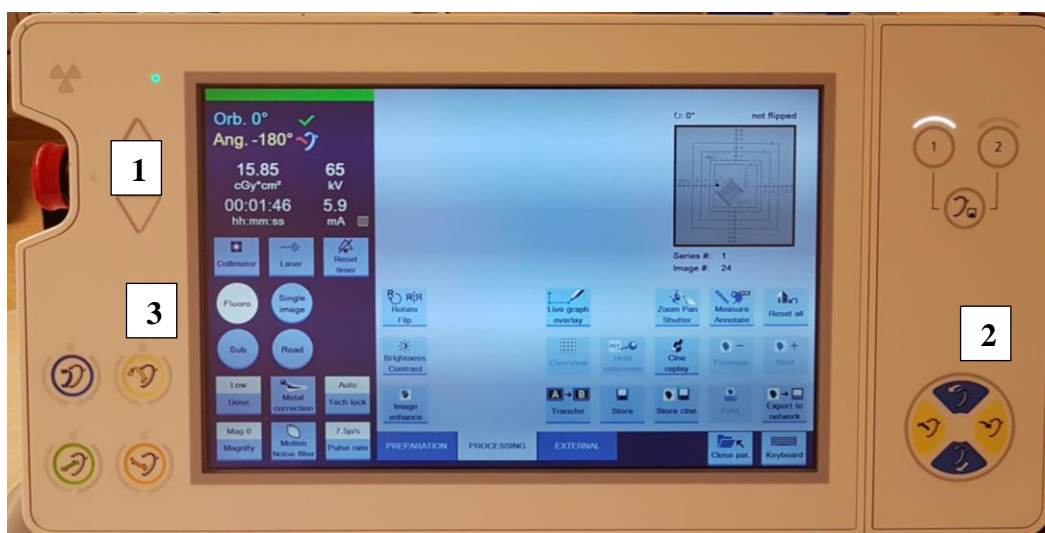
Figur 1: Dessa knappar på panelen justerar C-bågens läge
