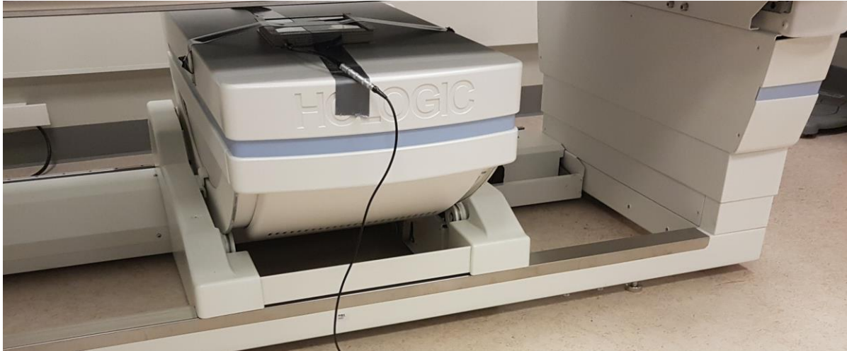
Figur 6: DAP-mätning utförs genom att placera DAP-mätaren på röntgenrörets öppning. Viktigt att tejpa fast DAP-mätaren, samt att kablarna inte är trasslade
