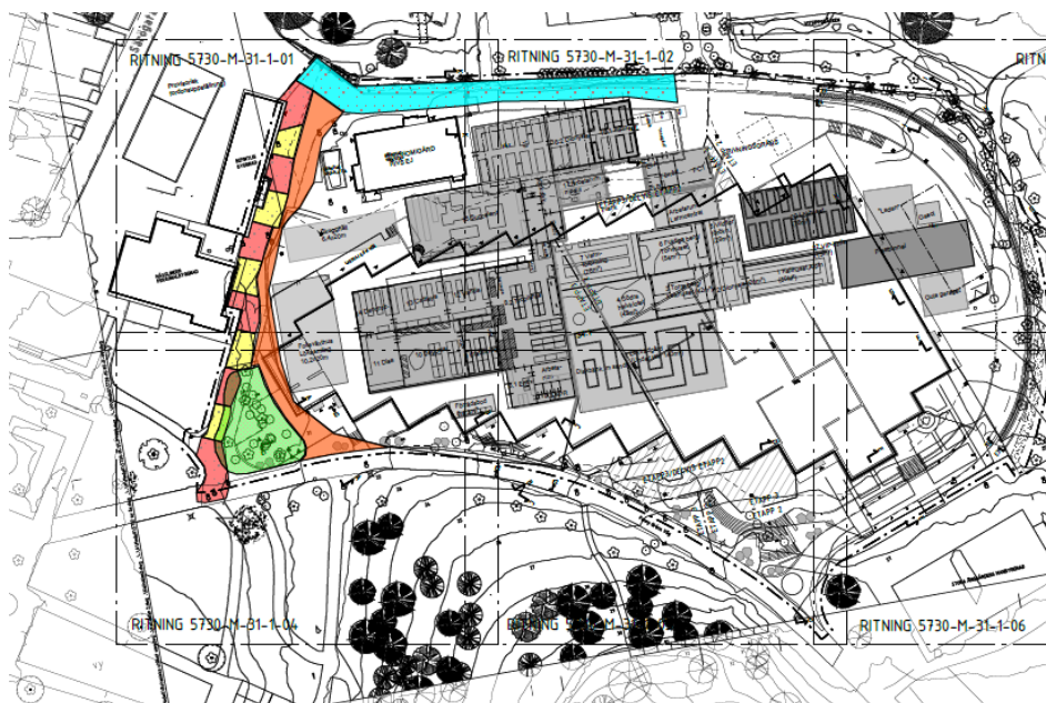
Figur 3. Område som berörs av arbete VA-schaktning och därmed påverkar framkomlighet för fordon på Fanny Gréns väg.
