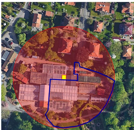
Figur 2: Röd cirkel symboliserar kranarmens rörelseomfång och blå linje den zon inom arbetsområdet där hängande last är tillåten.
