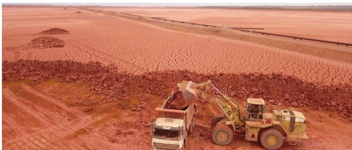
Figur 7. Hydros avfallsanläggning för torkning av bauxitrestes i Paragominas i Brasilien. 119
