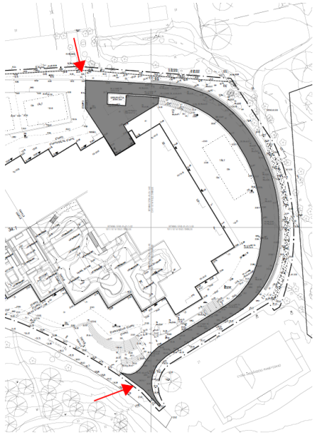
Figur 5. Område som skall asfalteras
