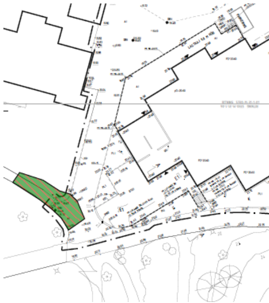
Figur 3. Område som berörs av omkoppling bevattning
