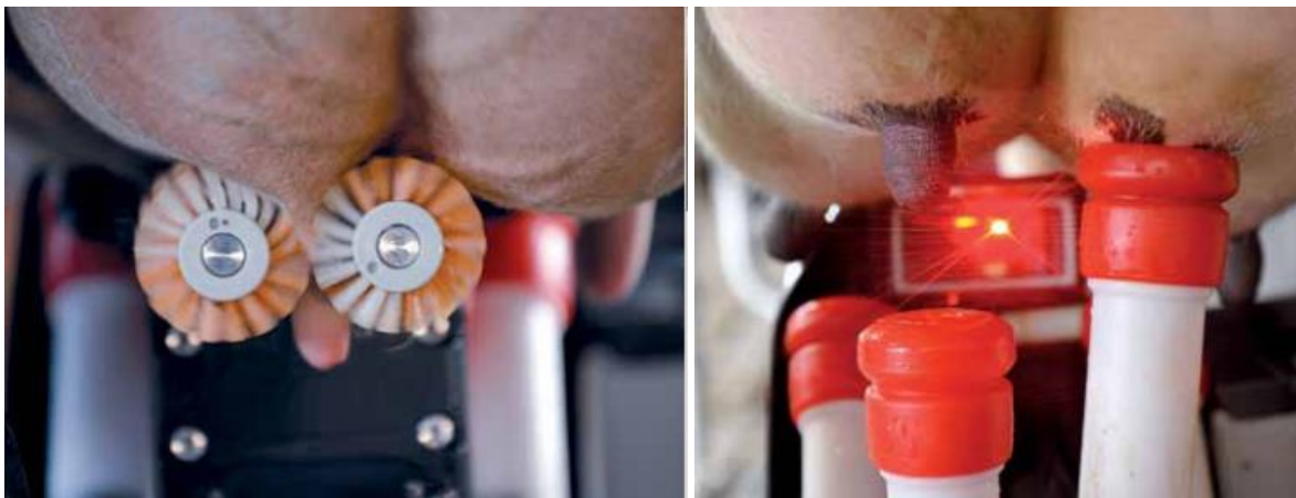
Figur 3. Robotmjölkning. Automatisk rengöring av spenar och lokalisering av spenar med laser (Foto: Lely)
