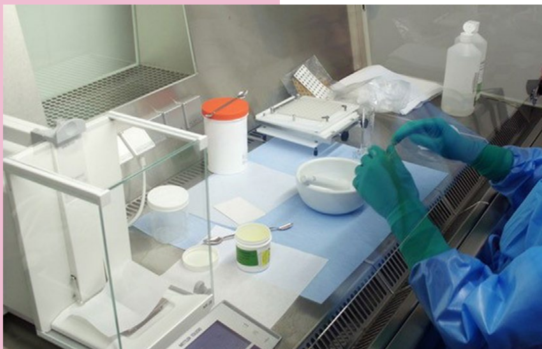
Figur 10-6: Produktion av kapslar i en mikrobiologisk säkerhetsbänk på Pharma Assist BV, Nederländerna. Användning av farliga läkemedel i pulverform är en högriskverksamhet som kan generera luftburna partiklar.
