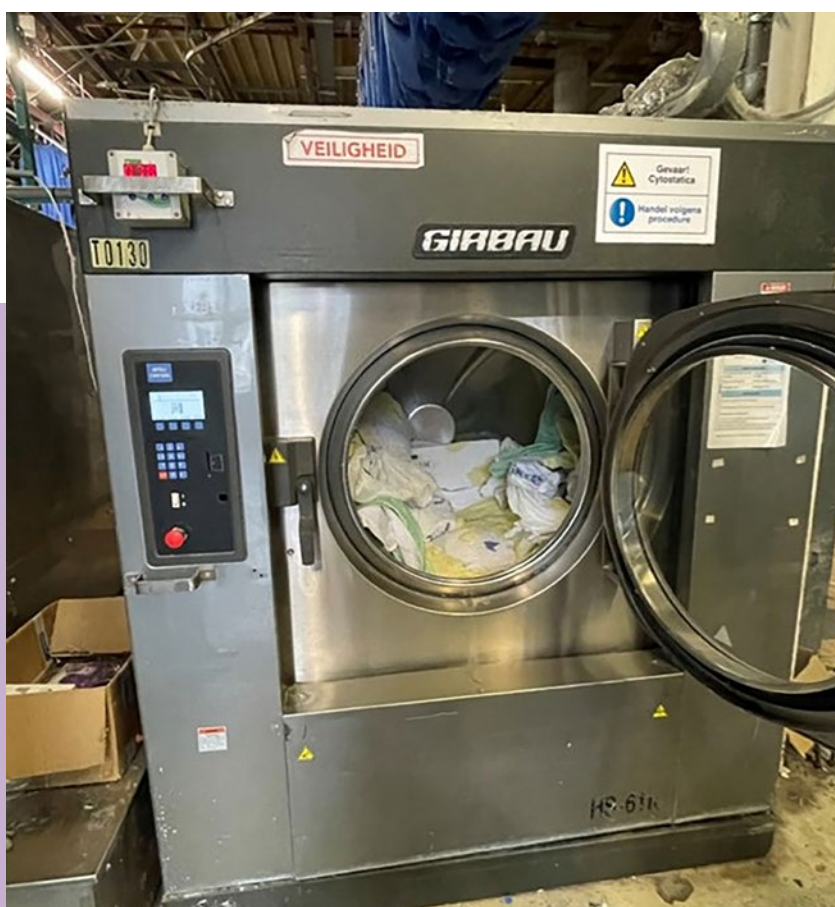
Figur 14-4: En separat första tvätt av tvätt kontaminerad med farliga läkemedel. Tvättpåsar för engångsbruk tvättas tillsammans med tvätten före bortskaffandet.
