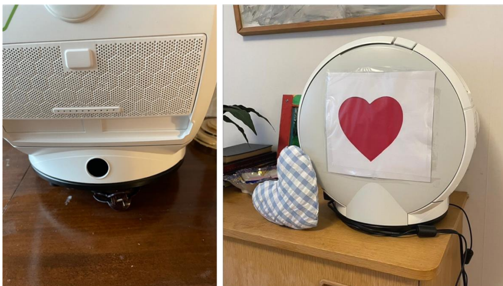
Figur 3. Anpassning av läkemedelsautomater, genomförda på demensenheten på ett särskilt boende i Göteborgs stad. Bilderna visar att man höjdt läkemedelsautomaten för att patienten tydligare ska kunna se var medicinerna kommer ut och att man täkt automatens lampa med ett rött pappershjärta för att dölja det gröna ljuset som uppfattades som obehagligt.
