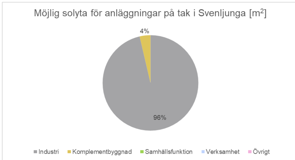
Figur 13: Fördelningen av möjlig yta för solcellsanläggningar med en storlek på minst 250 kW på tak i Svenljunga, fördelad över olika byggnadskategorier. Beräkningarna är inklusive anläggningar över gränsen för skattefri elproduktion vid 500 kW.
