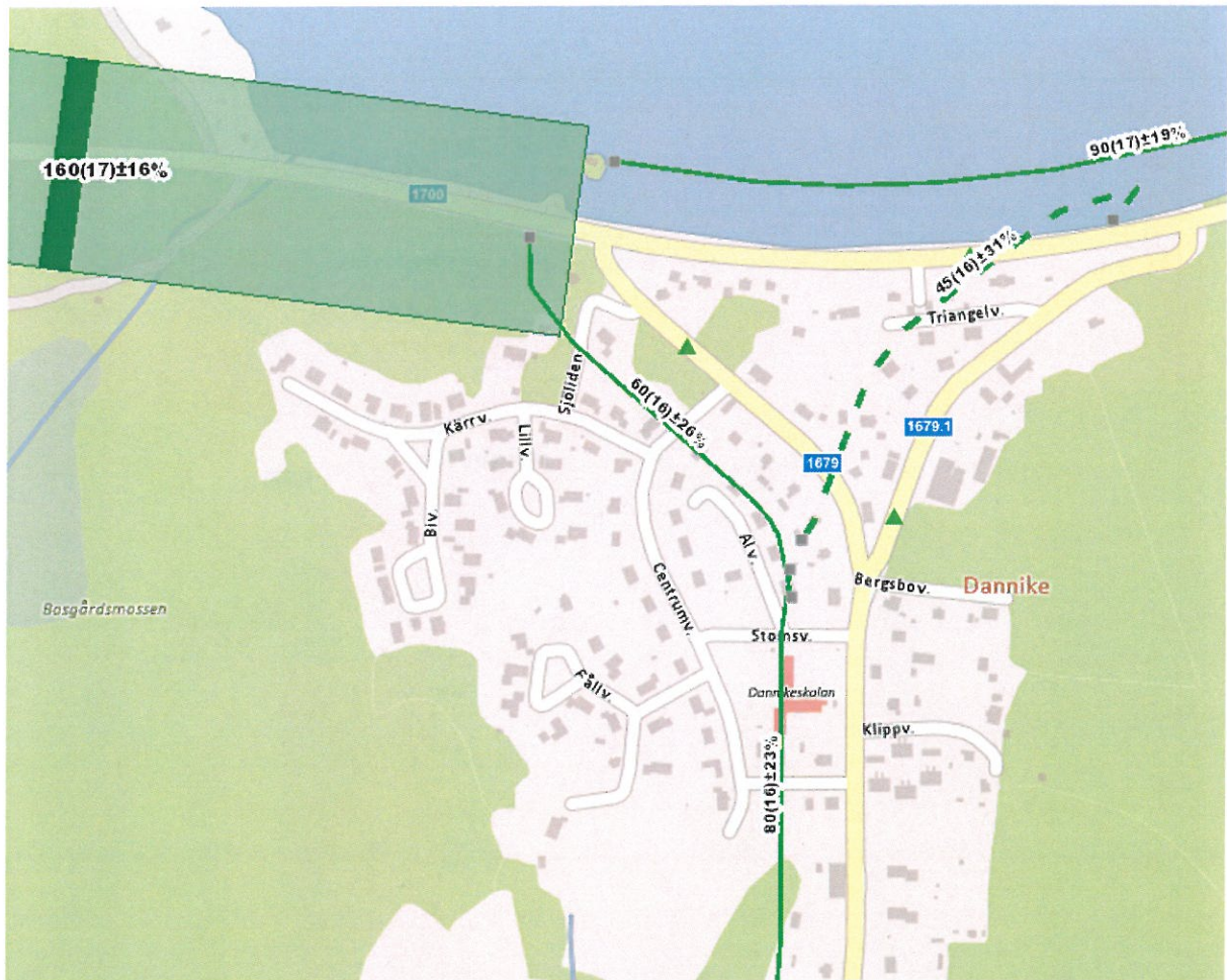
Figur 5 Årsmedeldygnstrafik tunga motorfordon enligt TFK, uttag 2019-07-17. Mörka streck markerar mätpunkter. Siffror i parentes anger mätår och procenttalet anger mätosäkerheten.
