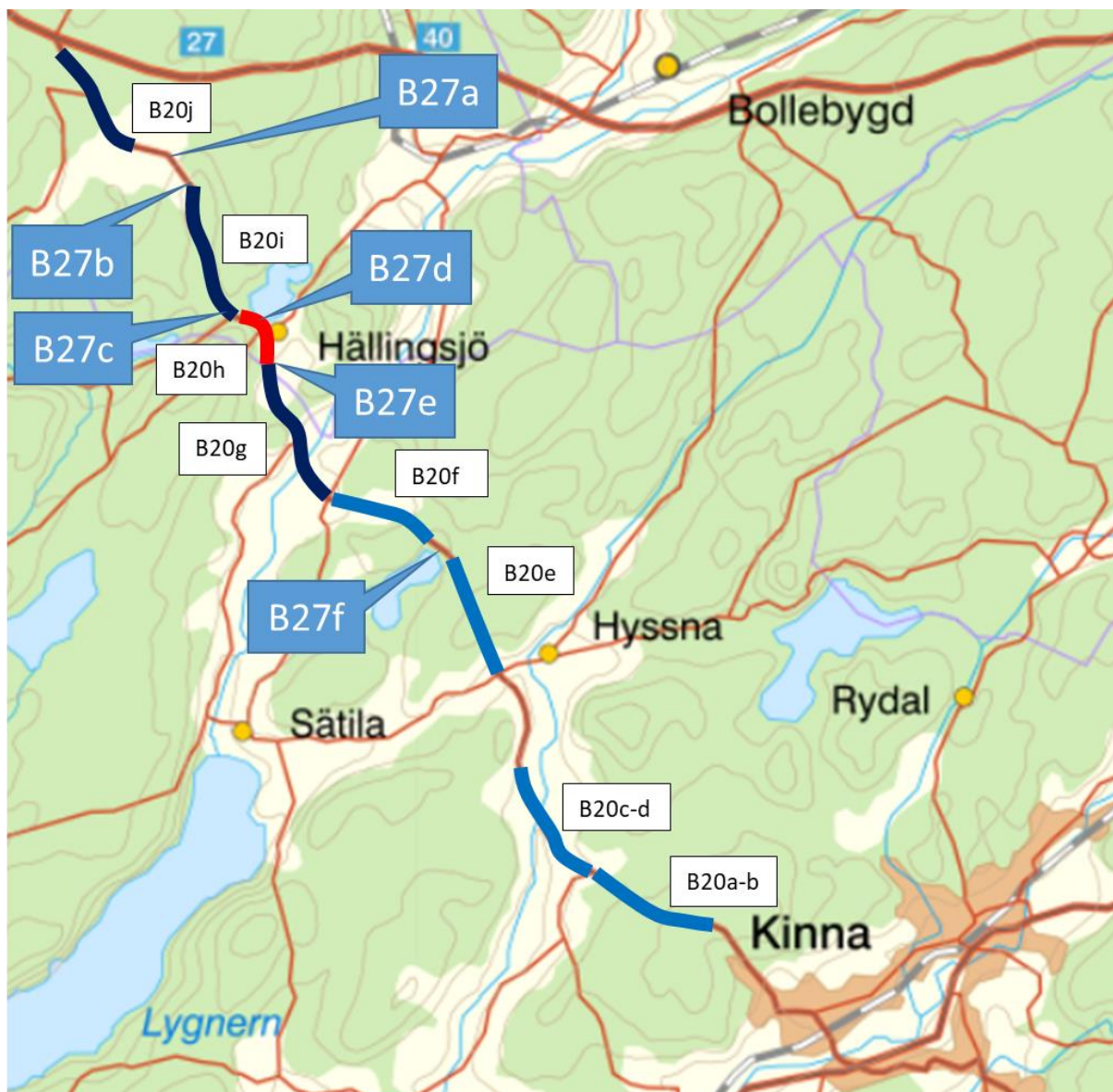
Figur 59. Föreslagna korsningar lämpliga för vänsterfält, B27a-f. Notera kombinationen med sträckor föreslagna för utbyggnad till mötesfri väg, åtgärd 20a-j.
