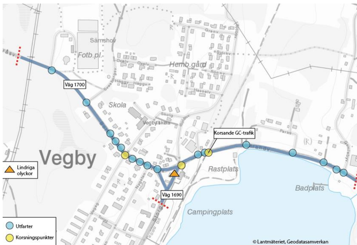
Figur 10 Korsningspunkter och utfarter samt registrerade olyckor
