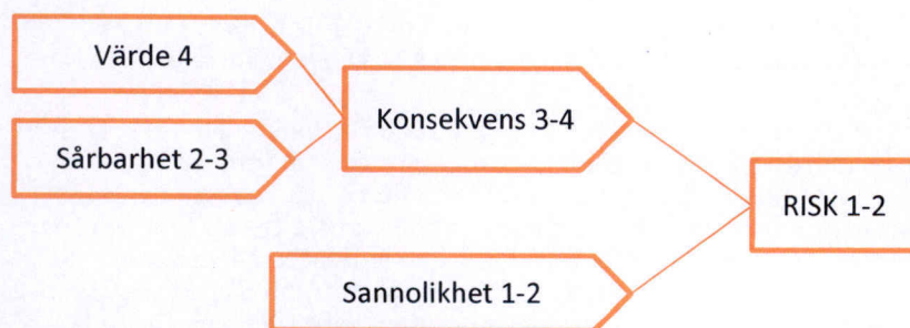
Figur 22 Schematisk bild av sammanfattande riskbedömning för Långhem vattentäkt och väg 1680
