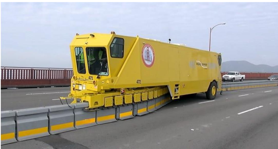
Figur 14 Maskinell flytt av betongbarriär
