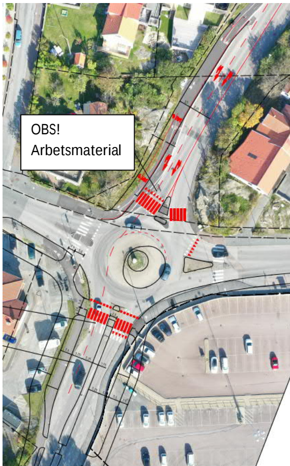
Figur 27: Utdrag från preliminär CAD-skiss över möjligheten att skapa två södergående körfält genom Norgårdsvägens cirkulation. Detta är den enda åtgärd som har visat sig nödvändig på huvudvägnätet på de sammanbundna öarna, på grund av framtida omfördelad och ökad trafik kopplat till en eventuell fast förbindelse.
