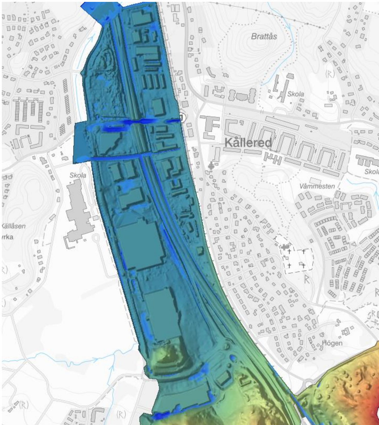
Figur 29. Översvämningssituation vid skyfall av ett 100-årsregn med klimatkfaktor 1,25, när åtgärderna 1N och 1S är genomförda. Vattendjupen som visas är > 20 cm, det vill säga det vattendjup där vägar bedöms bli oframkomliga för personbilar. För information om metod för beräkning se bilaga 1.
