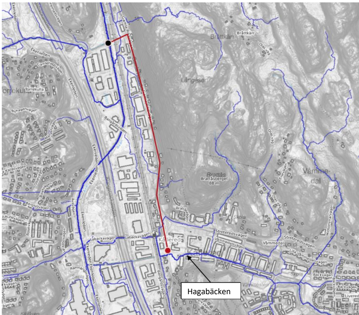
Figur 31. Principiellt förslag på omdirigering av Hagabäckens kulvert (röd linje). Blå linjer representerar dagens flödesvägar, på eller under markytan.
