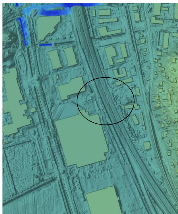
Södra området vid en beräknad vattennivå på cirka +10,09 vid Labackavägen.
