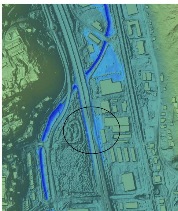
Norra området vid en beräknad vattennivå på cirka +9,86 vid E6 bro.
