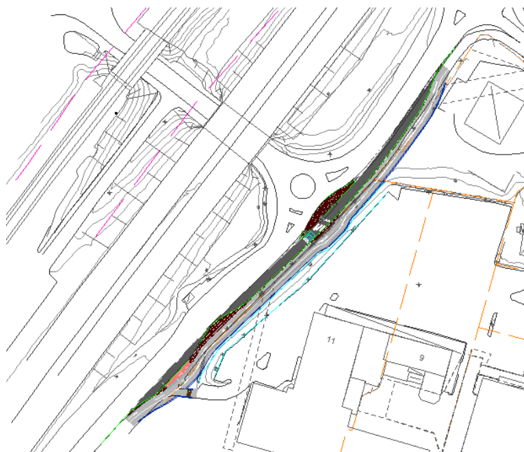
Figur 4 Trimningsåtgärd extra körfält Aspenvägen
