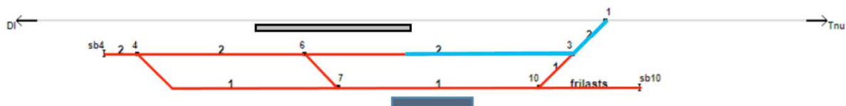
Figur 2. Rött visar de spår, samt delar av spår, där underhållet föreslås upphöra. Ljusblått visar de 200 meter av spår 2 som behålls för eventuell framtida upprustning, och som därmed inte ingår i förslaget om upphörande av underhåll.
