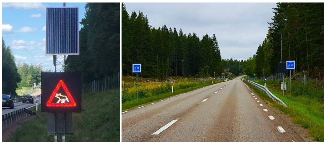
Figur 5. Exempel på skylt för viltvarning (vänster) samt skylt för rekommenderad högsta hastighet i kombination med radar och skylt som visar fordonets hastighet (höger).
