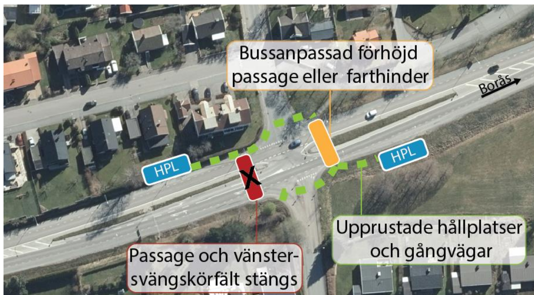
Figur 20. Gråbovägen, förslag till hastighetsreglering och ombyggnad av passager.
