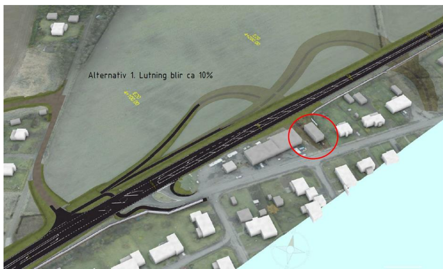
Figur 3. Illustrationsskiss från Projekt E20 förbi Hova. Två alternativa lokaliseringar av planskild GCM-tunnel studerades. Båda alternativen förutsatte placeringar nordost om anslutningen E20-Mariestadsvägen.
