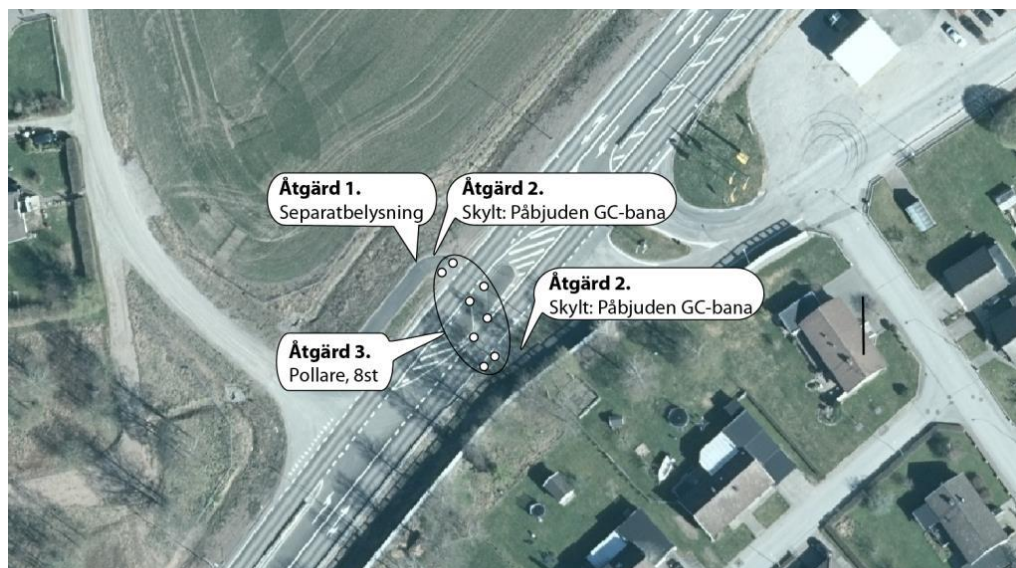
Figur 13 Placering av föreslagna åtgärder 1-3 (COWI, 2021-11-29)
