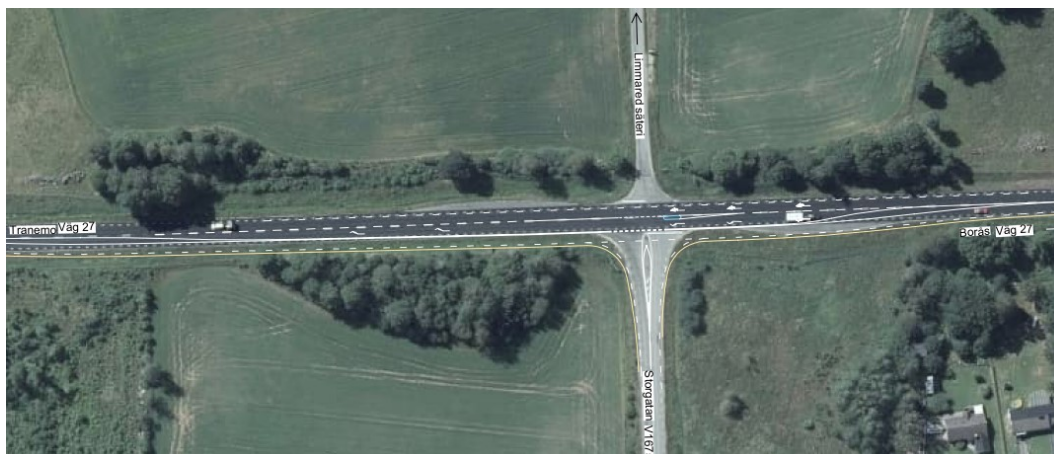
Figur 2. En möjlig lösning kan vara att anlägga vänstersvängkörfält på väg 27 i södergående riktning för svängande trafik in mot Limmared (väg 1675), samt vänsterpåsvängkörfält på väg 27 i södergående riktning. Vidare utredning får utvisa vilken utformning som är lämplig.
