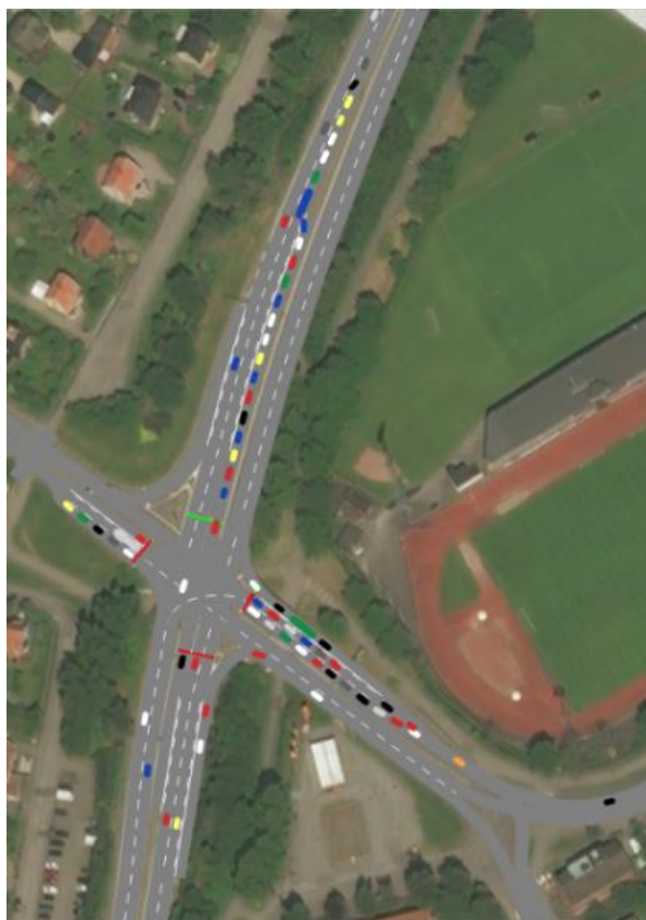
Figur 20. Åtgärd 2 under eftermiddagen, dagens trafik med befintliga signaltider.
