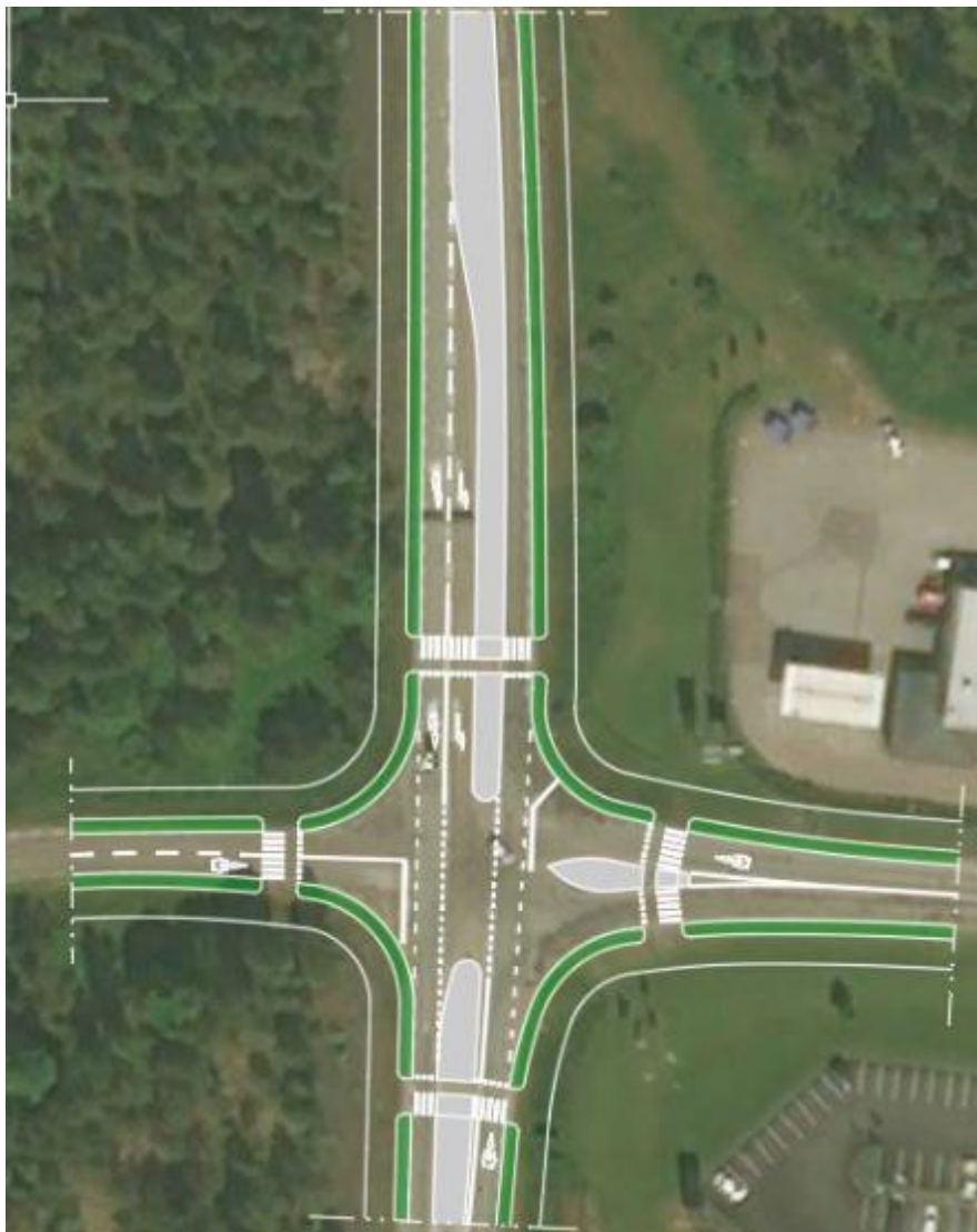
Figur 19 Exempel på ombyggnad av befintlig korsning
