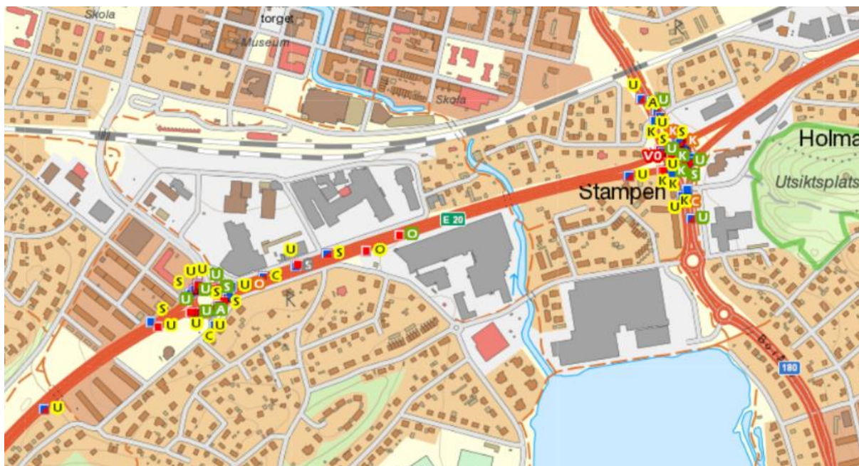
Figur 29. Registrerade olyckor inom utredningsområdet längs E20 och väg 180, perioden 2008-01-01 till 2017-12-31. Av figuren framgår att flertalet av olyckorna har skett i eller i anslutning till korsningarna Sveaplan och Götaplan, se även Figur 30 och Figur 31. I Tabell 1 framgår beteckningarna för de olika olyckstyperna. (Källa: Transportstyrelsen, 2018).
