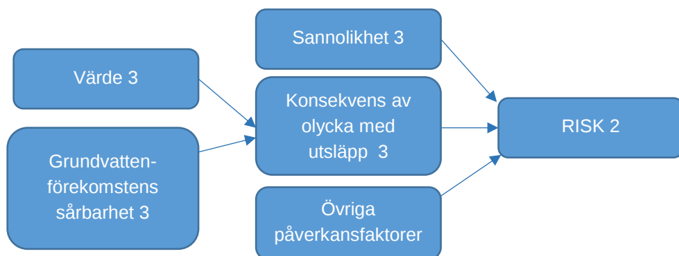
Figur 21. Schematisk bild av riskbedömning för Härrydas grundvattenförekomst, – delsträcka B - (olycka med utsläpp).
