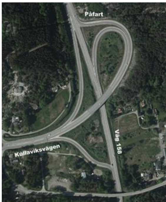
Figur 67. Trafikplats Kullavik, snäv och kort påfart.
