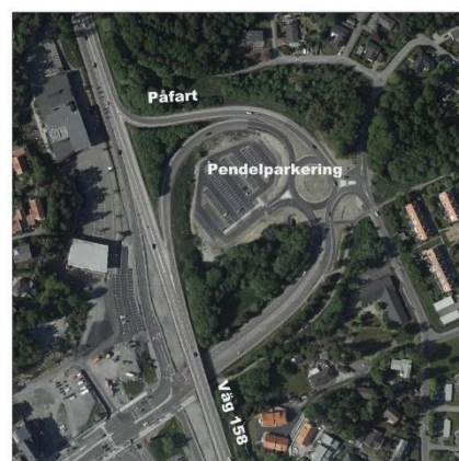
Figur 62. Brottkärrsmotet, kraftig kurva vid påfart. Pendelparkering med 146 platser.
