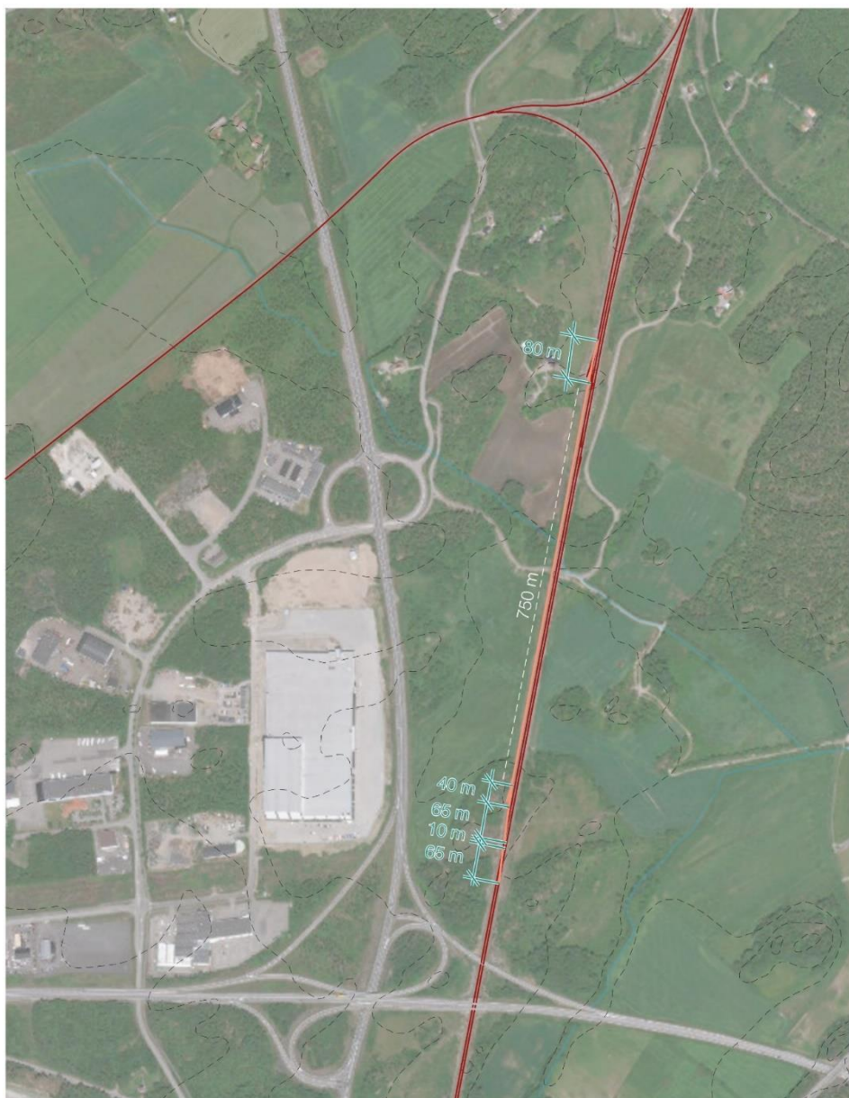
Figur 13 Föreslagen lokalisering av förbigångs- och vändspår i Öxnered.
