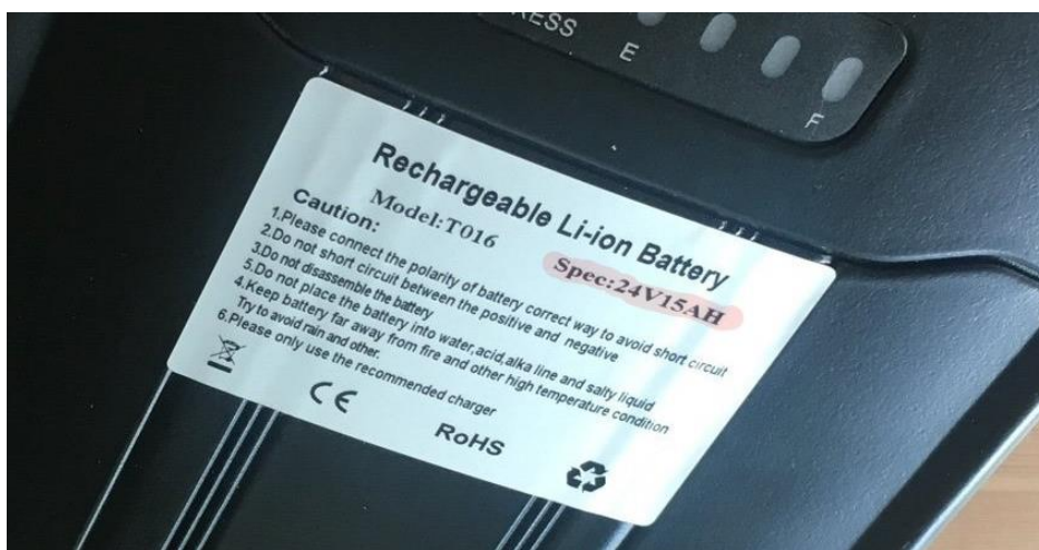
Figur 1. Exempel på litiumjonbatteri, kapacitet 360 Wh.
