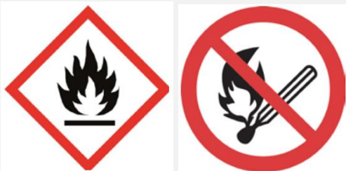
Figur 14. Exempel skyltning, brandfarlig vara och eldningsförbud, ur MSBFS 2023:2.
