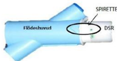
Figur 12. Spirette + DSR i flödes huvud. Se till att trianglarna är i linje tillsammans med den gröna pricken.
