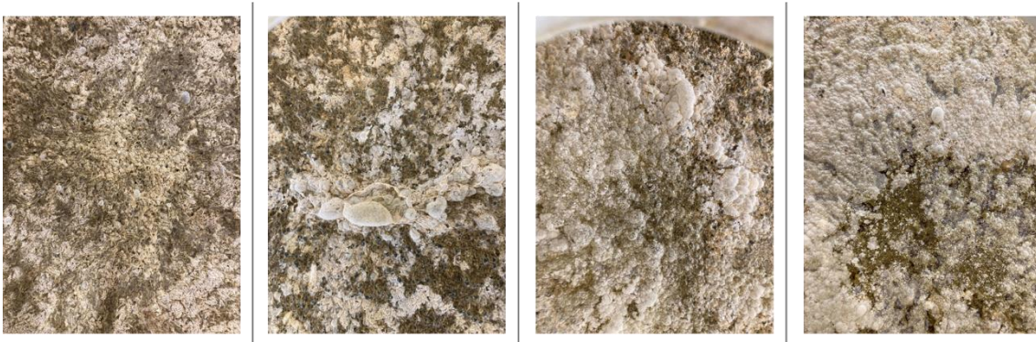
Figur 12. Från vänster till höger, mögeltillväxt vid ytan vid provtillfälle dag 7, 14, 21 och 28.
