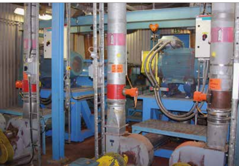
Vikplåtar. Dessa används för att vika massan då Dan Webb-kvarnarna inte kan ta så samma bredd som övriga kvarnar och genom detta kan man använda samma bredd på alla massarullar oavsett vilken kvarn de ska till. Foto Patrik Olofsson.
