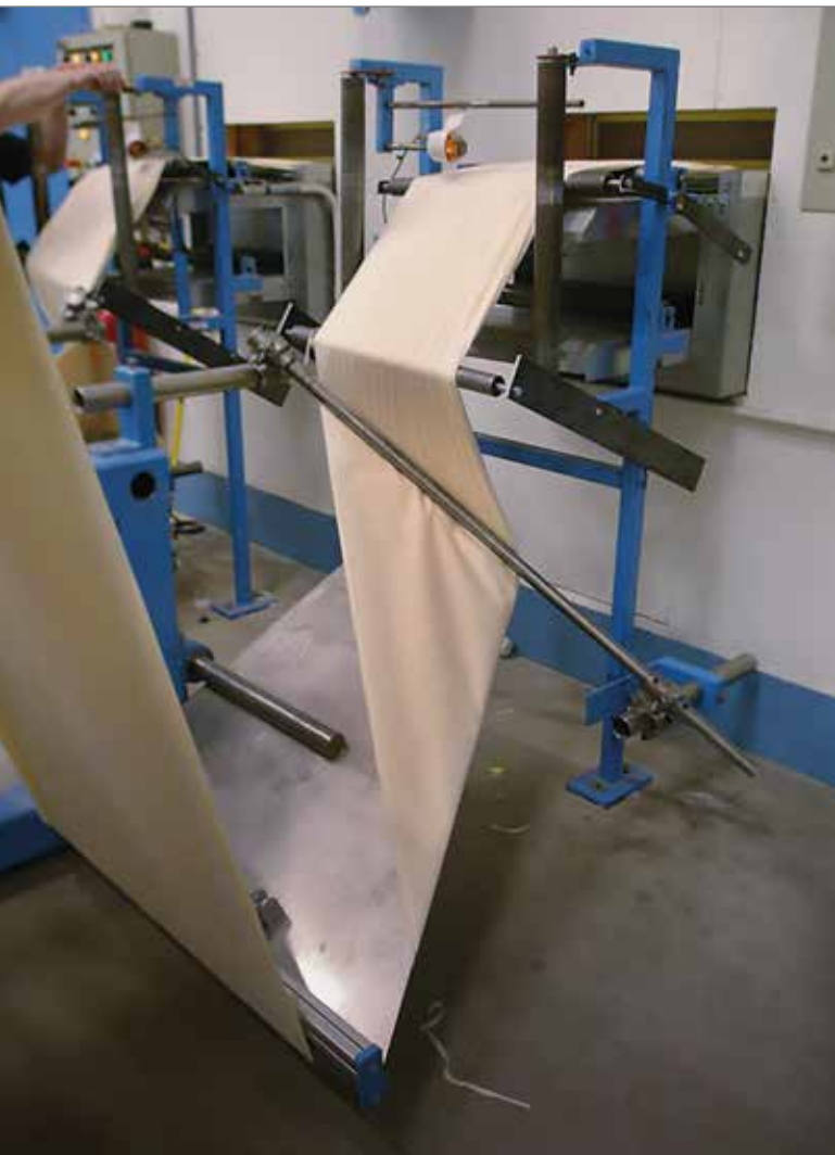
Vikplåtar. Dessa används för att vika massan då Dan Webb-kvarnarna inte kan ta så samma bredd som övriga kvarnar och genom detta kan man använda samma bredd på alla massarullar oavsett vilken kvarn de ska till. Foto Patrik Olofsson.
