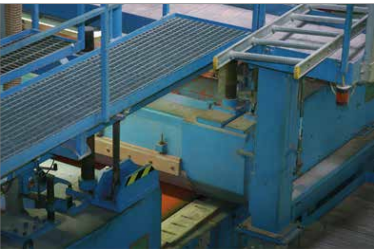
Fotot visar två ITK-kassar som blåser på massa på viran. Notera viran som nu har börjat beläggas med massa.
