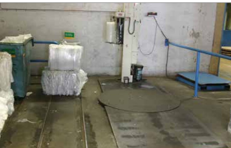
Rullsvepsmaskin i byggnad 2. Spåret till vänster är en rest av de smalspåriga transportbanorna som var vanliga förr på denna typ av industrier innan truckar tog över deras transportuppgifter.
