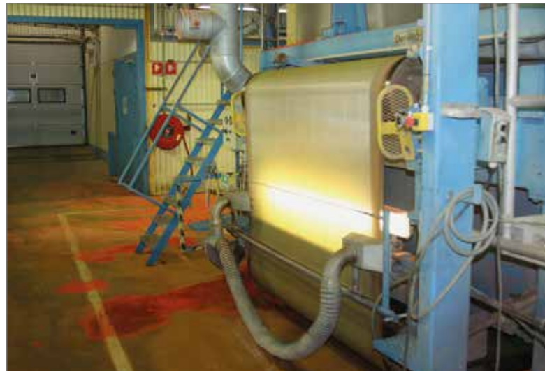
Viran på väg in i Dan Webb-kassen för att beläggas med massa.
