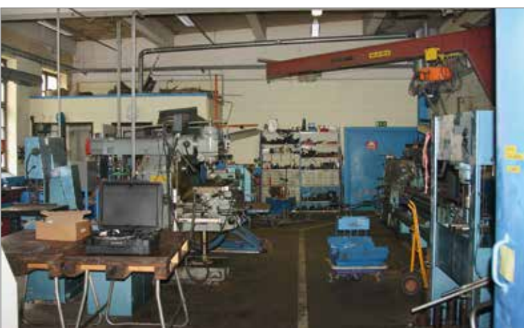
4b, mekaniska verkstaden. Till höger en hydraulpress, bakom den metallsvarven och i mitten över- och vertikalfräs. Till vänster en metallbandsåg. Till höger en svängkran med en motoriserad lyftanordning, en så kallad telfer.
