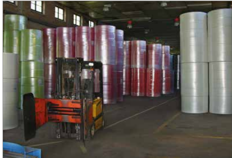
Byggnad 2. Papperslager på våning 2. Trucken är utrustad med lyftanordning för pappersrullarna.
