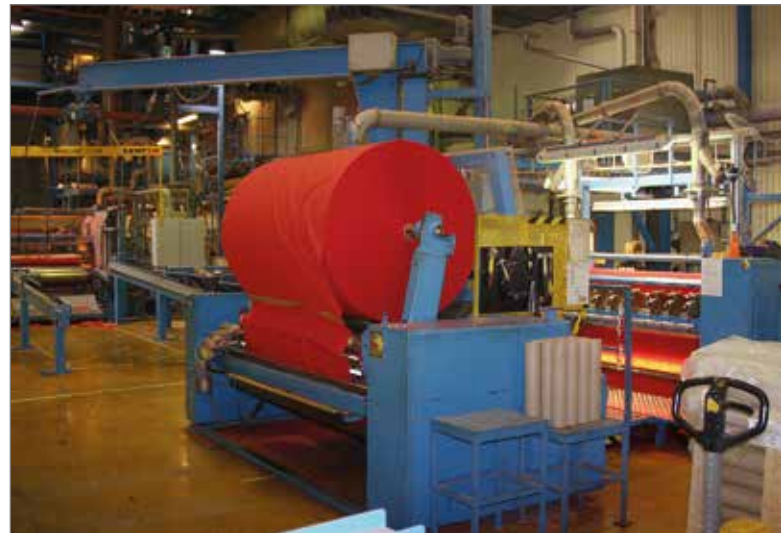
Rullen har nu placerats i rullmaskinen. Till höger syns skärmaskinen som delar upp rullen i mindre rullar. Skärningen sker med knivar.
