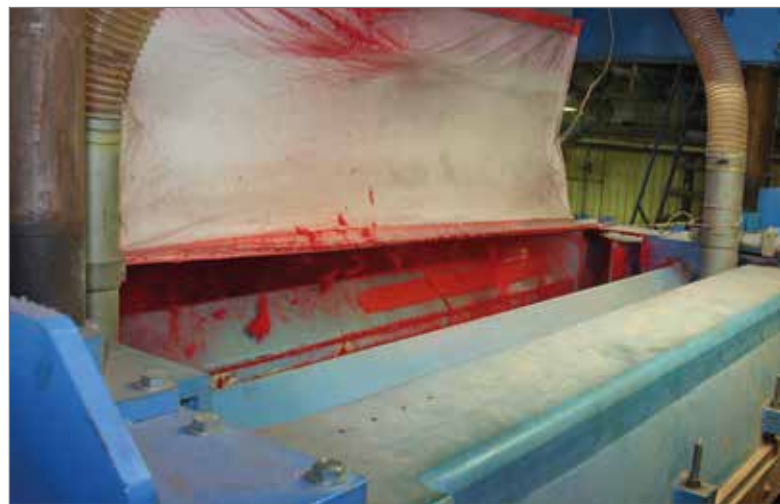
ITK-kasse. Massan blåses ner mot viran och restprodukterna som passerar genom viran hamnar i ITK-filtret.
