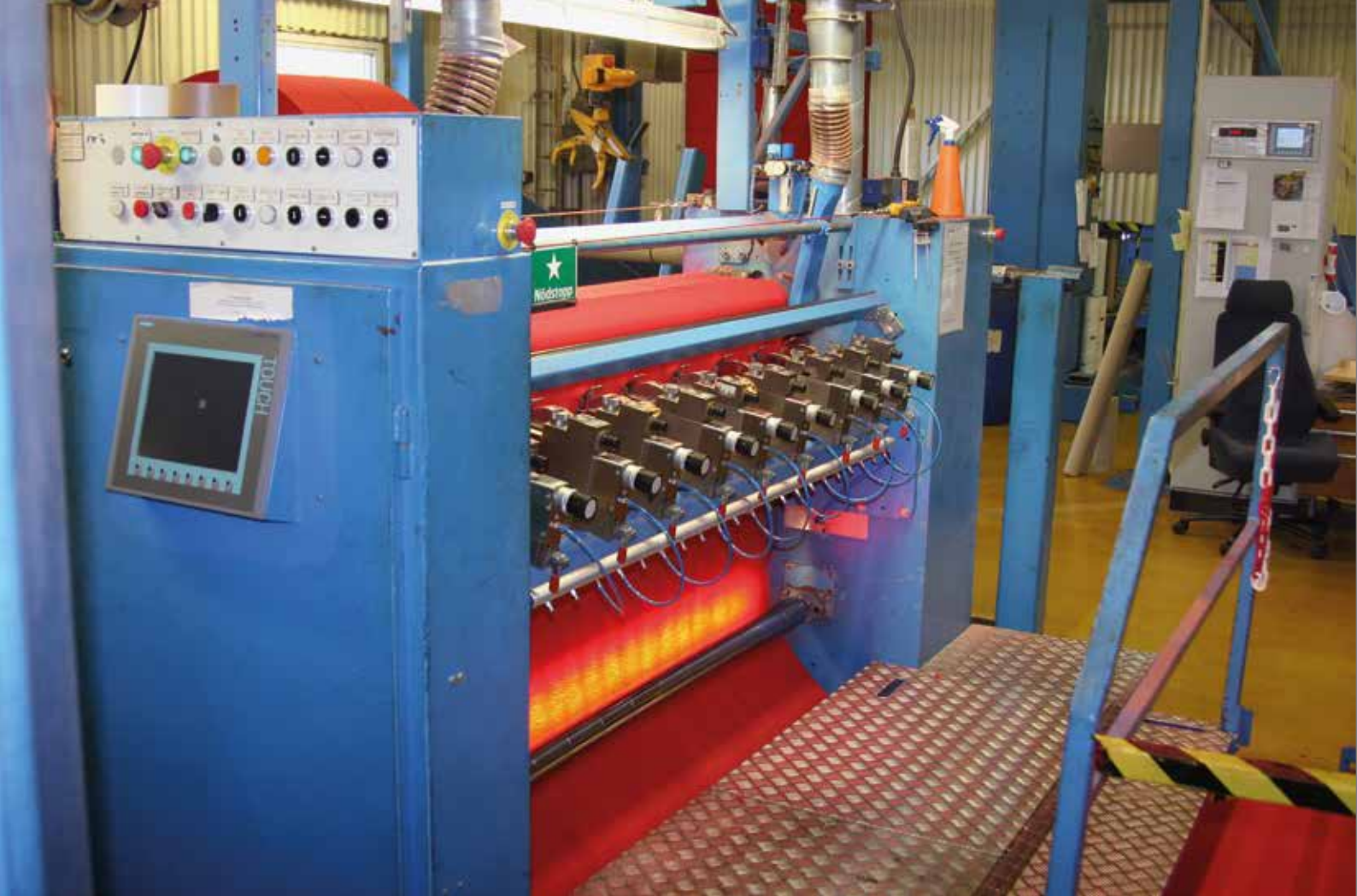
Skärmaskinen med tryckluftsjusterade knivarna som skär pappret och fördelar pappret från den ursprungliga rullen i mindre rullar.
