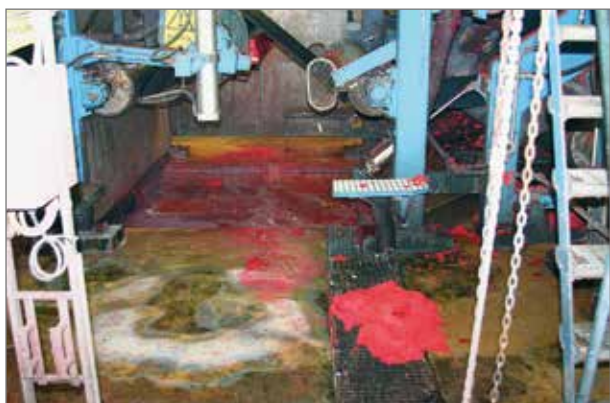
Vid rengöring av TM 2 blandas vattnet med rester från produktionen. Blandningen går sedan via golvbrunnar och kulvertar till reningsverket.
