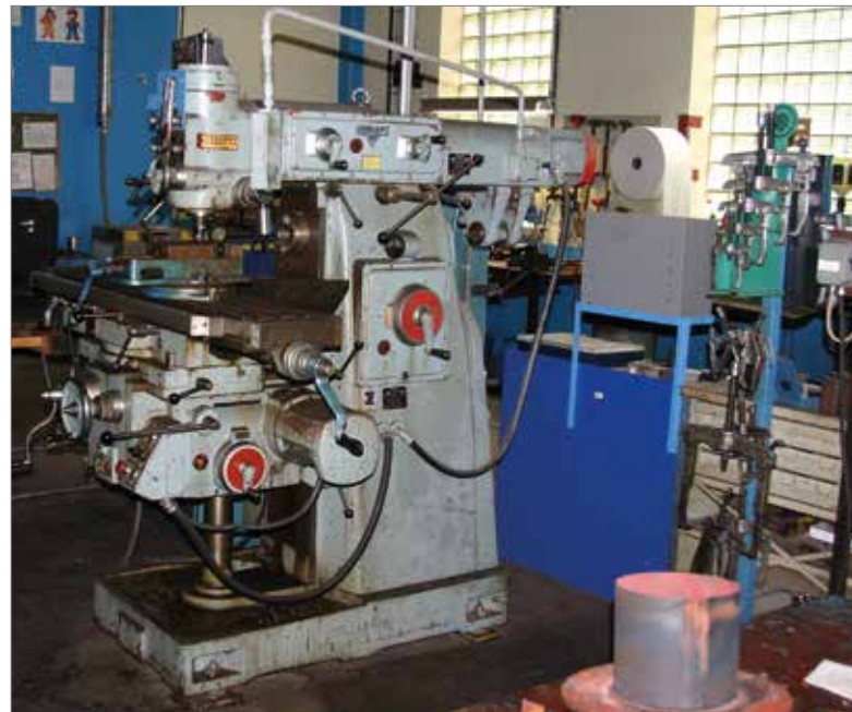
4b, mekaniska verkstaden. Över- och vertikalfräs. 1970? I bakgrunden en handbläster.
