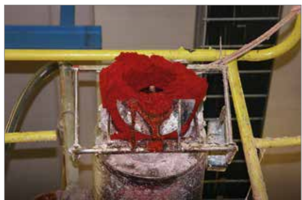
Kvarvarande restprodukter efter reningsprocessen pressas genom ett munstycke och samlas upp i containers. Innehållet körs sedan till destruktion.
