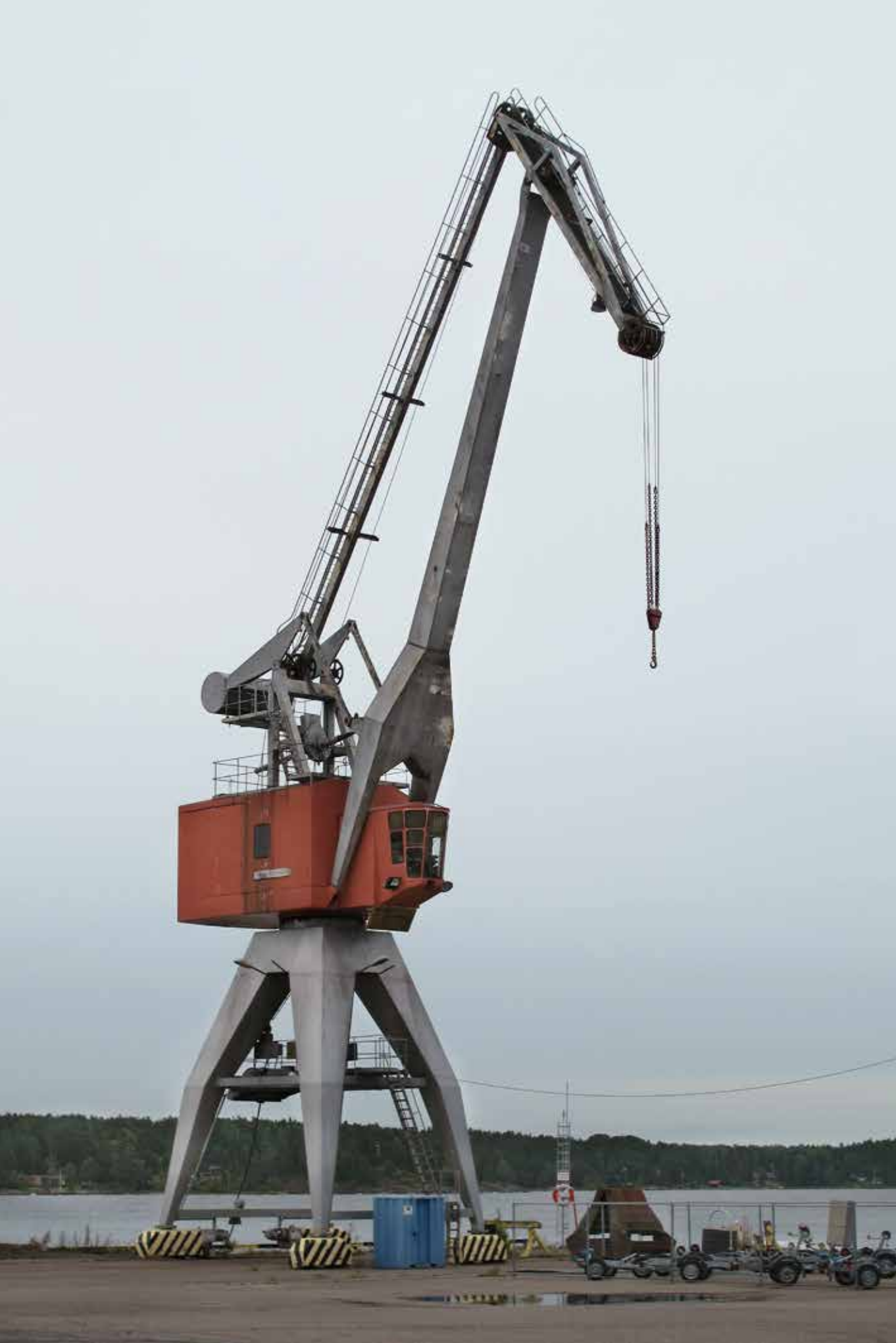
Hamnkranen i Åmåls djuphamn tillverkades av Århus maskinfabrik AS i Danmark och hamnade i Åmål 1966. Djuphamnen i Åmål är belägen söder om stadens centrum och är troligen en av Vänerns mindre för nyttotrafik. Kranen – av typen vipparmskran – löper på ett spår längs kajen, och kan lyfta fem ton. Foto Lars Bergström.
