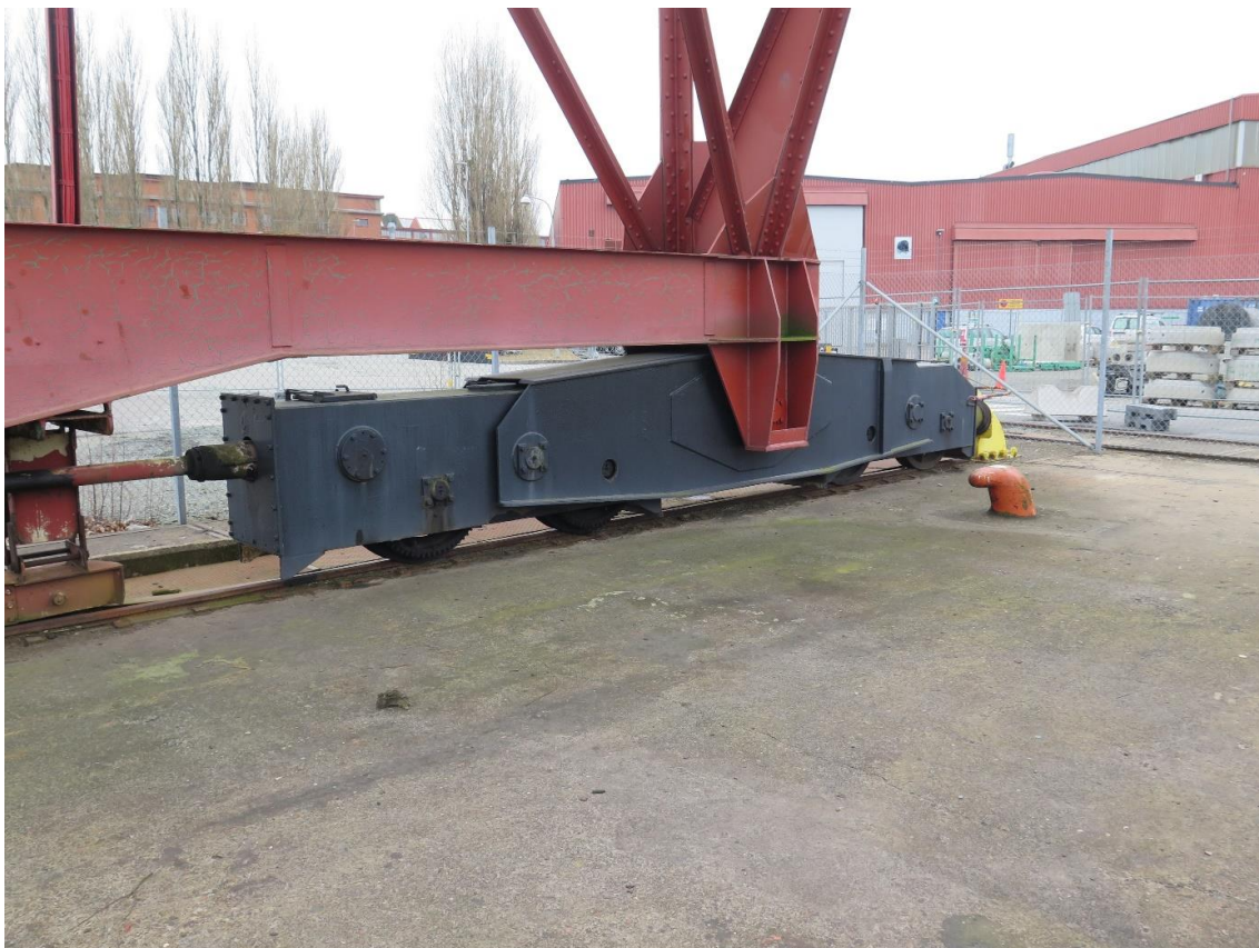
Boggin på södra portalbenet. Till vänster ses elmatningen och kardanaxeln från den centralt placerade elmotorn.
