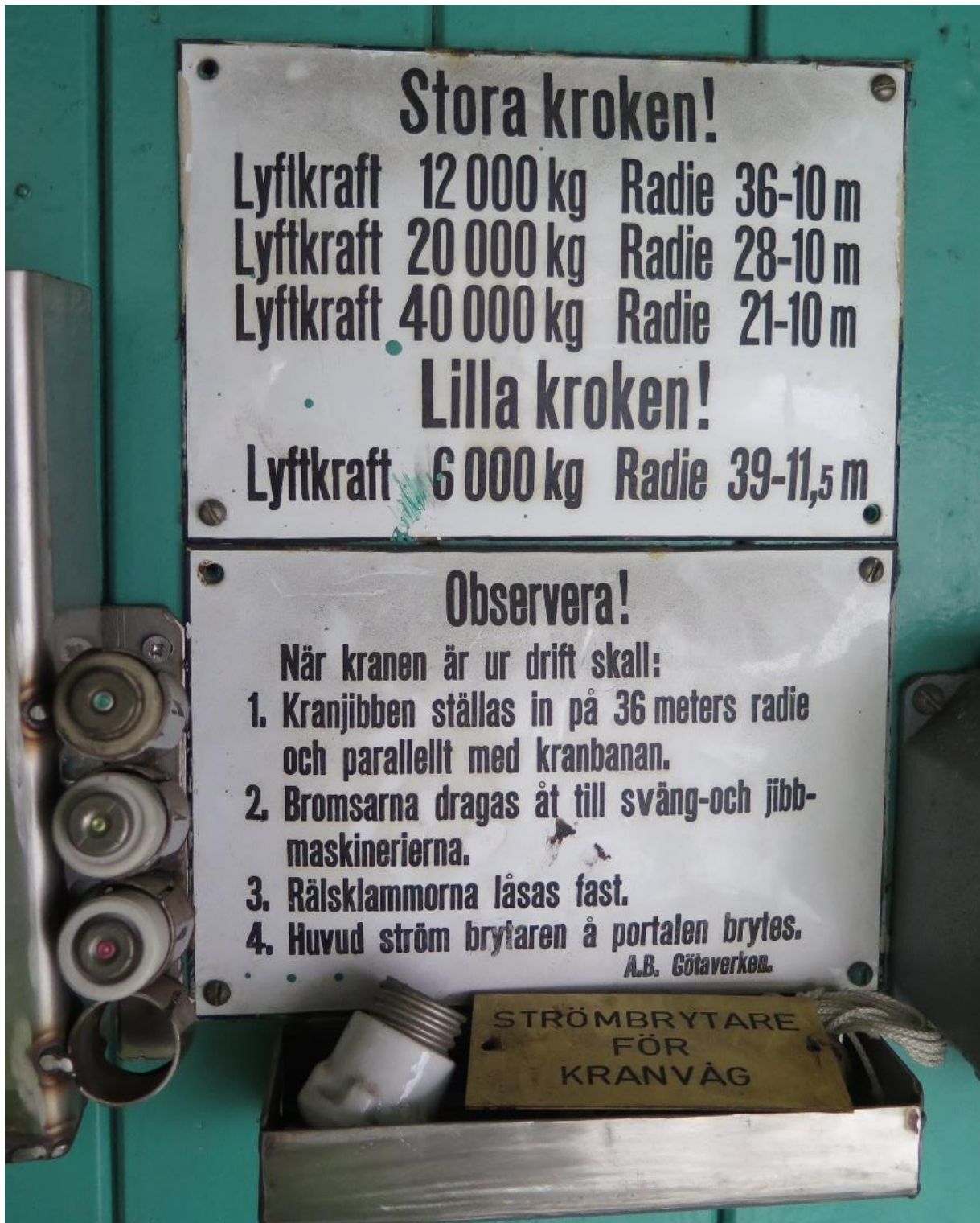
Emaljskylt placerad i förarhytten. Till höger och vänster om skylten ses olika anordningar för elen i kranen vilka är vanligt förekommande på många platser i både maskinrum och förarhytt.
