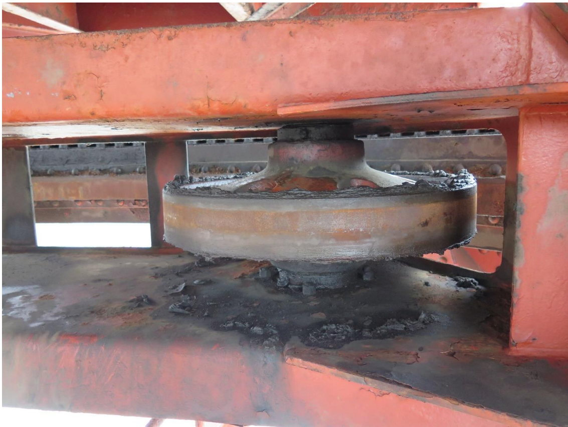
Stödshjul som håller hytten och kranjibben i läge när det körs runt. Kuggarna för drivningen skymtar i bakgrunden.
