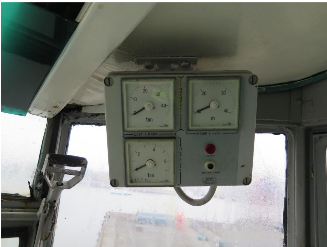
Mätarna som anger kranjibbens utlägg i meter och antal ton i stora och lilla kroken. Mätaren nere till vänster är till lilla kroken. Den ovan till stora kroken. Mätarna monterades troligtvis in mellan 1975-80.
