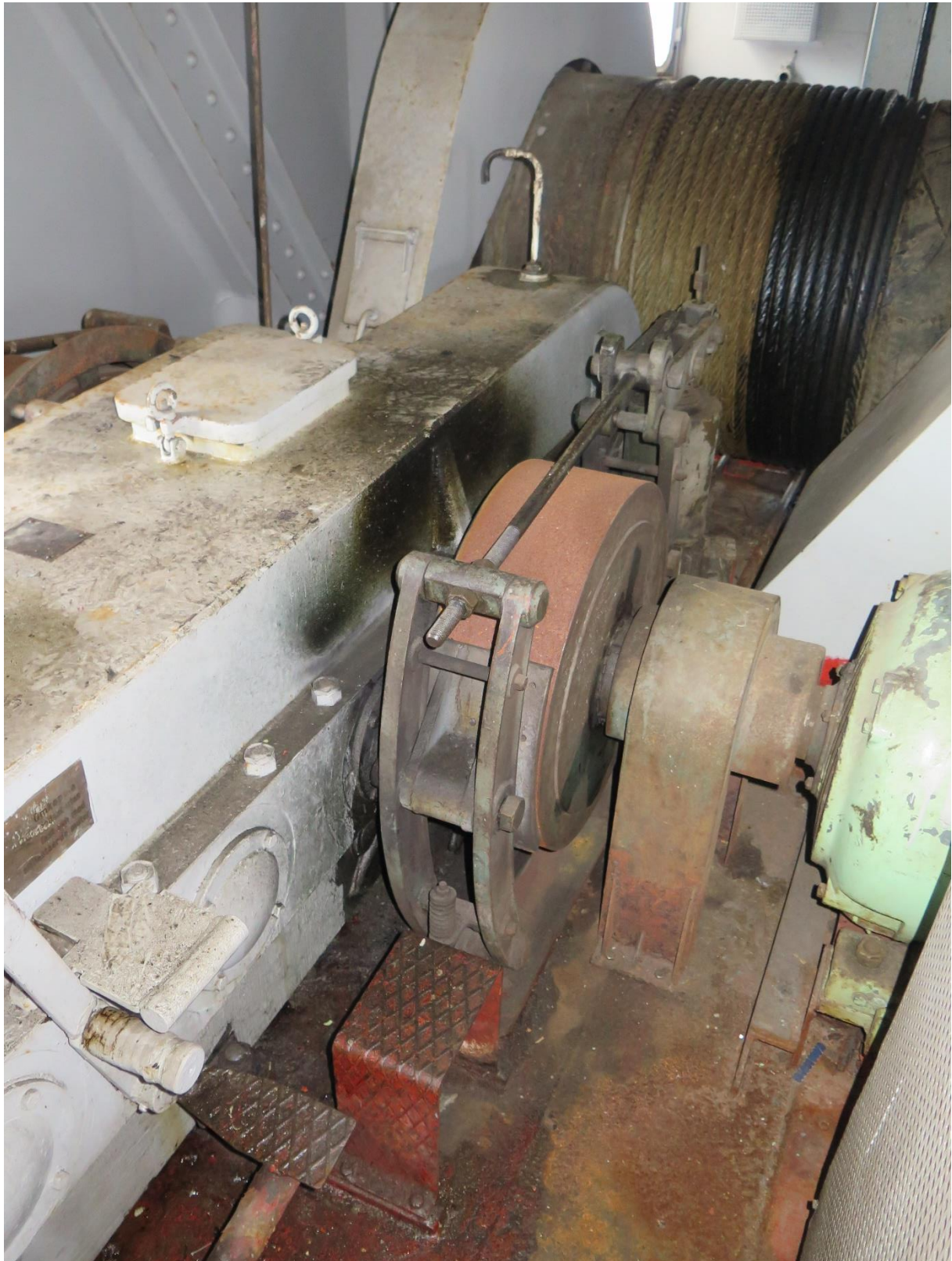
Växellåda och bromsanordningar. Bromsningen sker genom att bromsblock pressas mot ett centralt placerat hjul mellan växellåda och motor. Motsvarande broms skymtar på andra sidan växellådan.
