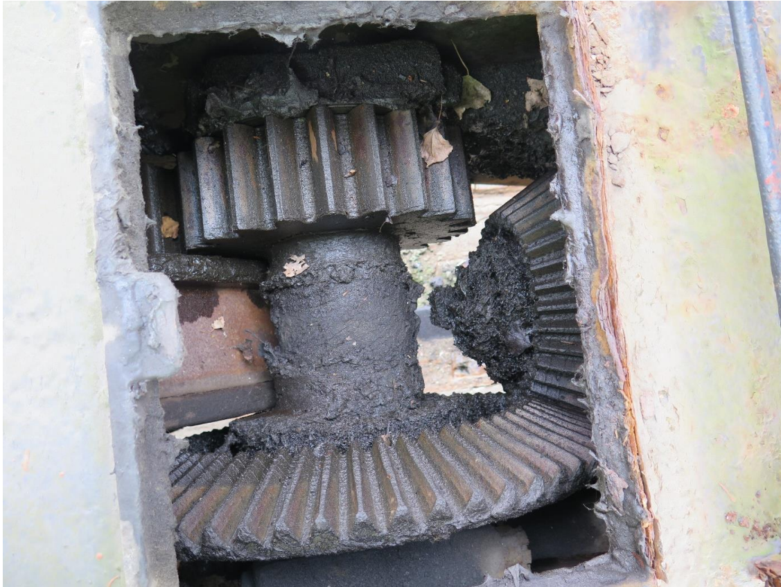
Kuggar till en av boggierna. Till vänster ses ett av de dubbelflänsade hjulen. Till höger ses kuggdrevet som sitter på ingående kardanaxel. Genom att flytta det mellan kuggarna erhålls fram eller backgång.
