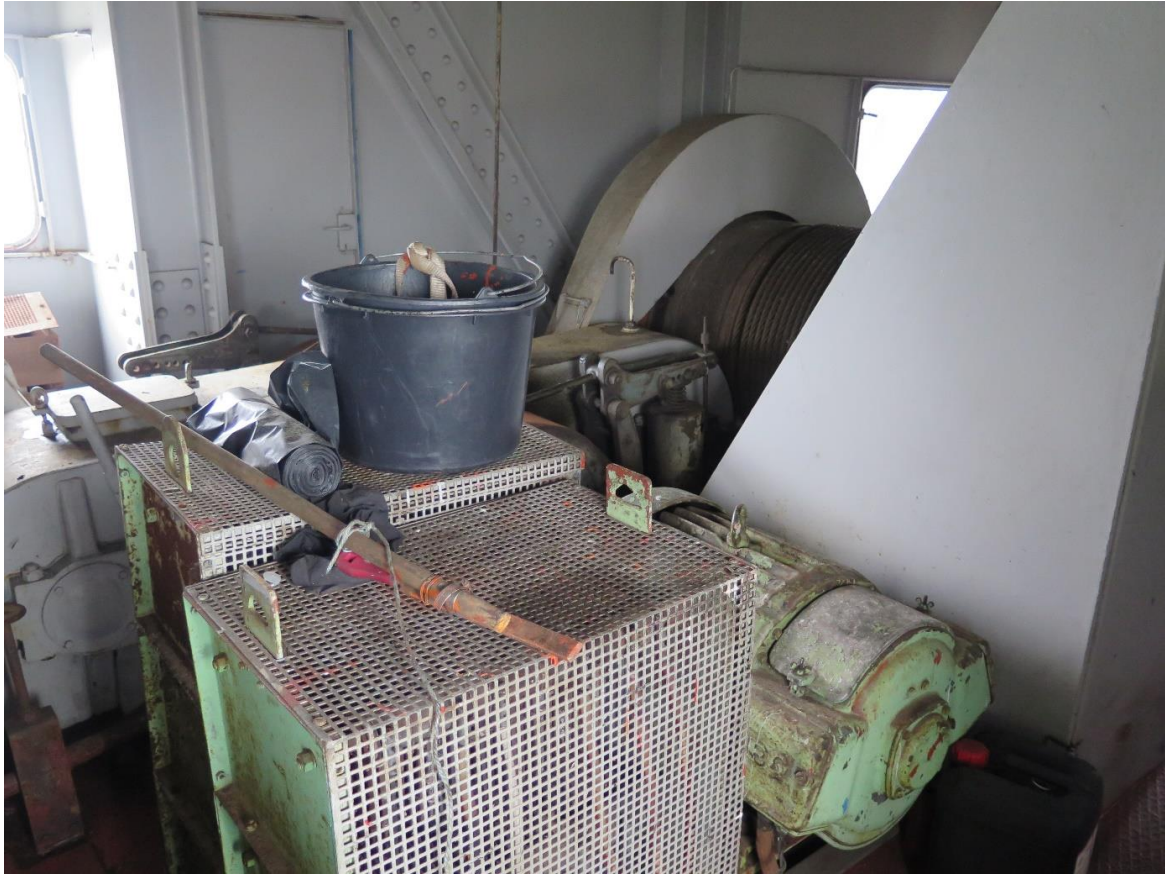
En elmotor av tillverkning AEG driver både stora kroken och kranjibben. Val av funktion sker via en snäckväxel som regleras från förarhytten.
