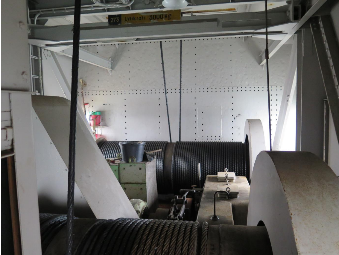
Mellan vajertrummorna finns växellåda och bromsar för vajerarna. Väggen i bakgrunden är också motvikten vilken väger ett ansenligt antal ton.
