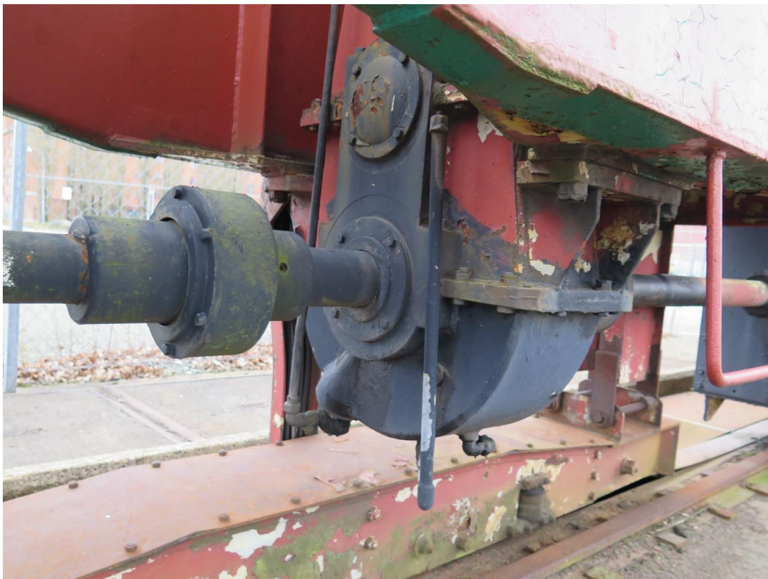
Foto mot sydväst. Elmotor med utgående kardanaxlar till boggierna.
