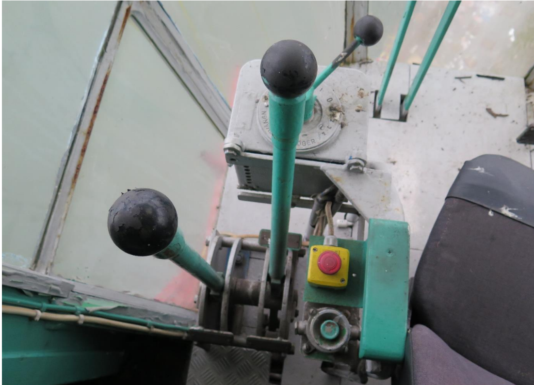
Växelspakar för val mellan att köra med kranjibben eller stora kroken. Dessa två gick på samma motor. Reglaget framför används till svängmotorerna för att svänga hytten och kranjibben.
